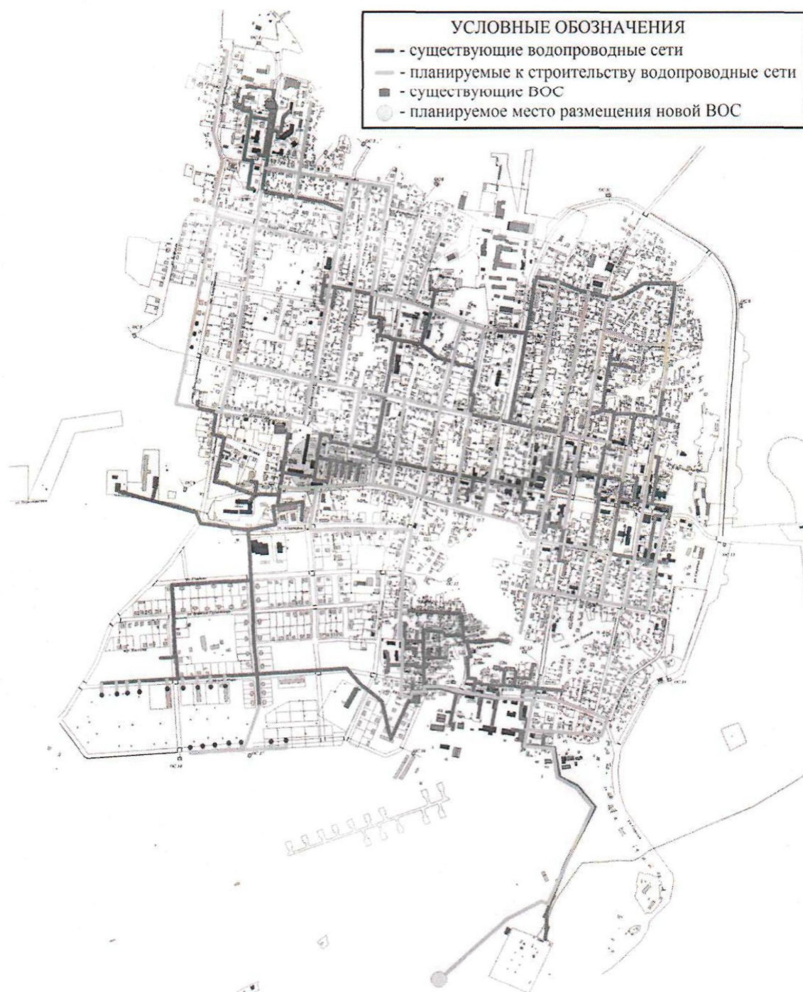
Рисунок 1 – Места прохождения новых водопроводных сетей для подключения существующих зданий и сооружений
