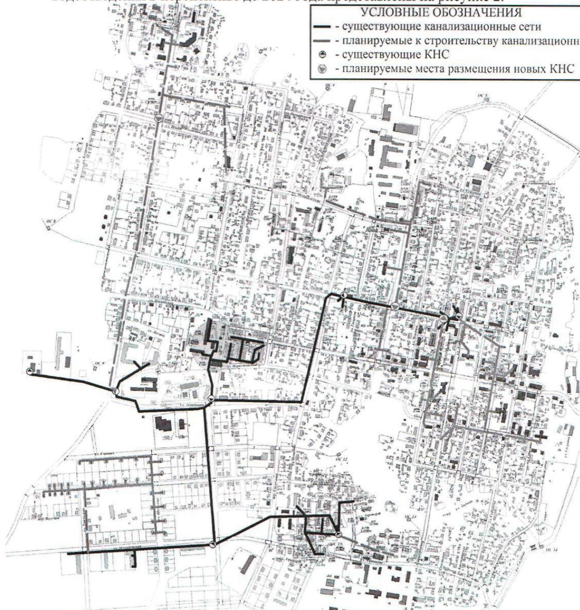
Рисунок 2 – Места прохождения новых канализационных сетей для подключения существующих зданий и сооружений
